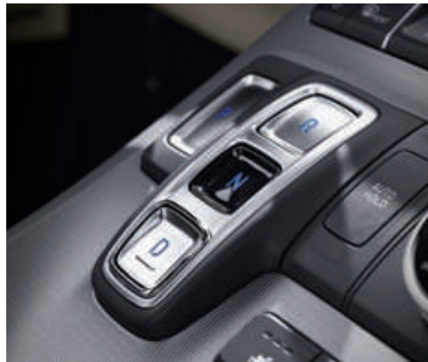
Переключение режимов 8-ступенчатой автоматической коробки передач кнопками
