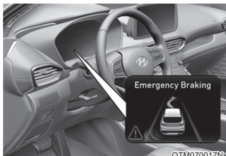
Вспомогательная система предотвращения столкновения (при движении)
