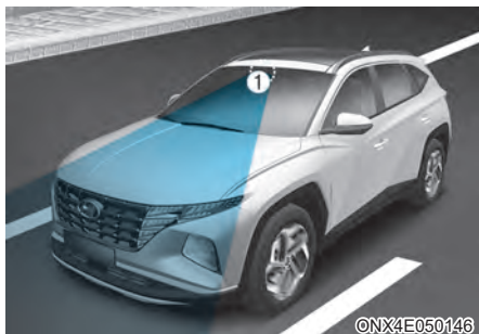
[1]: камера переднего обзора
