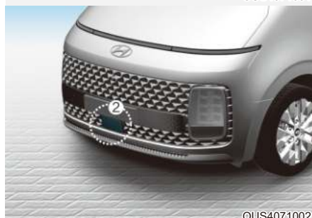
[1]: Камера фронтального обзора, [2]: Фронтальный радар
