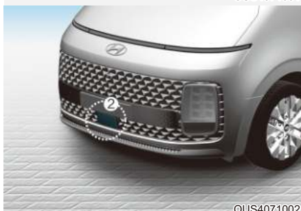
[1]: Камера фронтального обзора, [2]: Фронтальный радар
