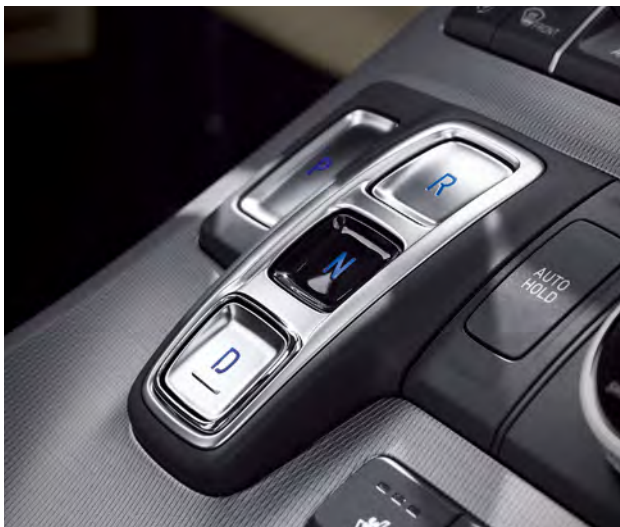
Переключение режимов 8-ступенчатой автоматической коробки передач кнопками
