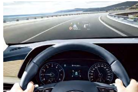
Проекция показаний приборов на лобовом стекле
